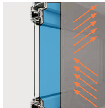
Außenliegender Sonnenschutz wirkt am effektivsten.
