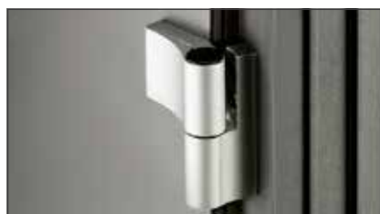
2 zweiteilig, aufliegende Türbänder, dreidimensional verstellbar, in EV1*
